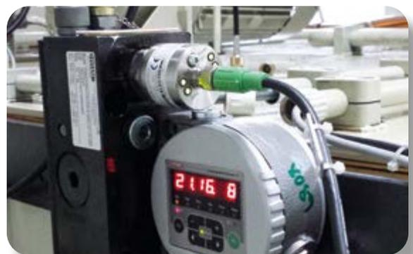
Condition Monitoring liefert permanent Daten zu unterschiedlichsten Parametern wie Temperatur, Füllstand, Druck, Partikel oder Wassersättigung.
